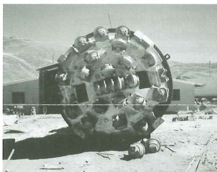
TBM für den Vortrieb Bocatoma, Cochabamba, Bolivien
